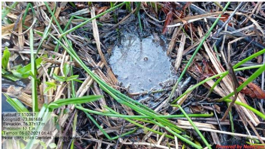
Fotografía 2. Suelo y agua subterránea contaminada con hidrocarburo – IANR Cardales, Fuente: SCSG.
