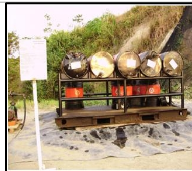
Fotos 80 a 82. Sitios de disposición de residuos sólidos, almacenamiento de productos químicos y de aceites; organizados dentro de una localización donde se desarrollan labores de perforación, obsérvese la impermeabilización del suelo con geomembrana y la debida señalización.
